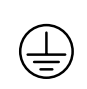
Classe I: apparecchi con parti metalliche costantemente collegate al circuito di terra
